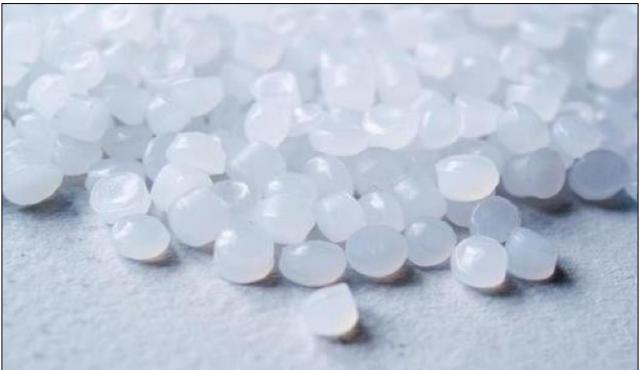
Foto 2 – Granuli di polipropilene naturale utilizzati per la produzione
