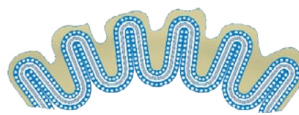
Cartuccia con elevato deposito
